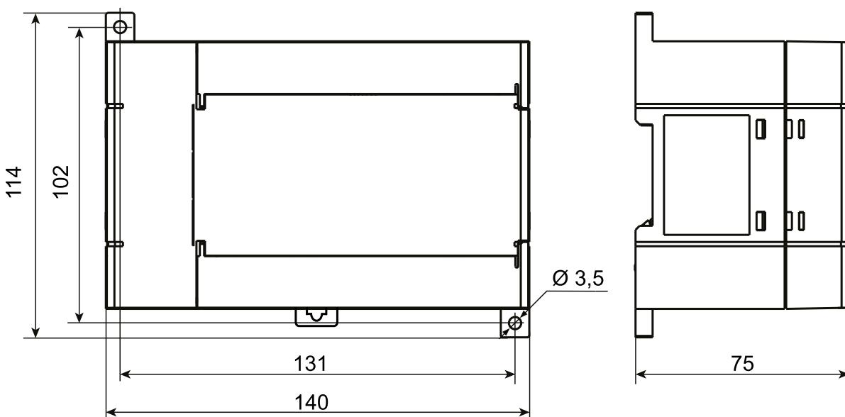
Рисунок 4.2 – Габаритные и установочные размеры прибора MB110-224.4ТД
