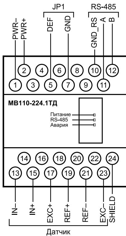
**Рисунок 5.2 – Назначение контактов клеммной колодки MB110-224.1ТД**
