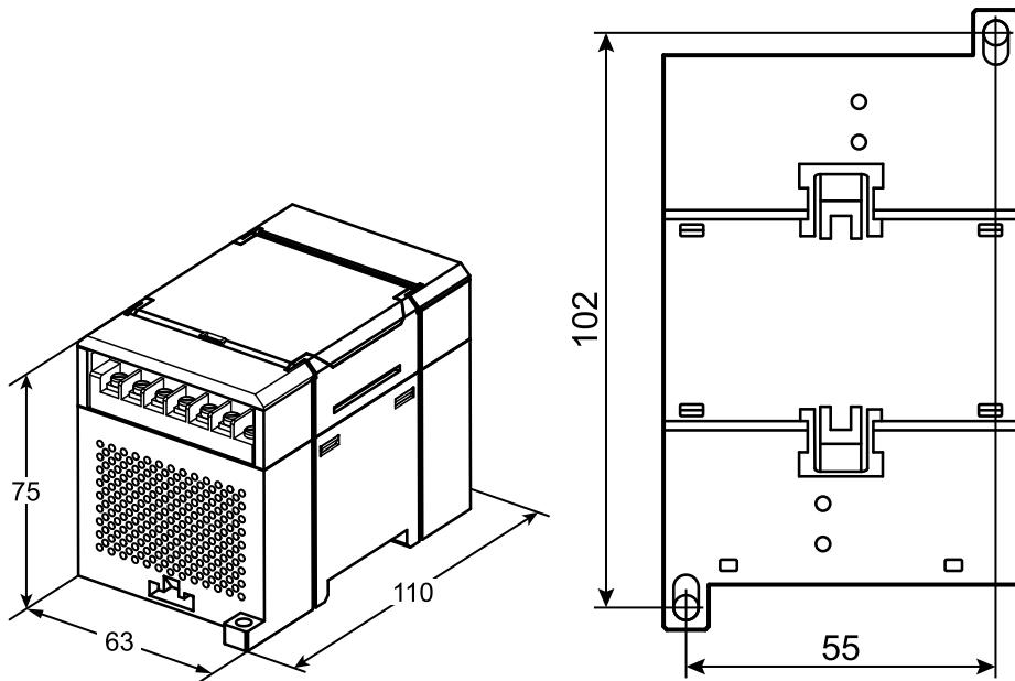
Рисунок 4.1 – Габаритные и установочные размеры прибора MB110-224.1ТД
