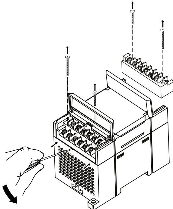
**Рисунок 4.3 – Отделение клеммной колодки от прибора MB110-224.1ТД**
