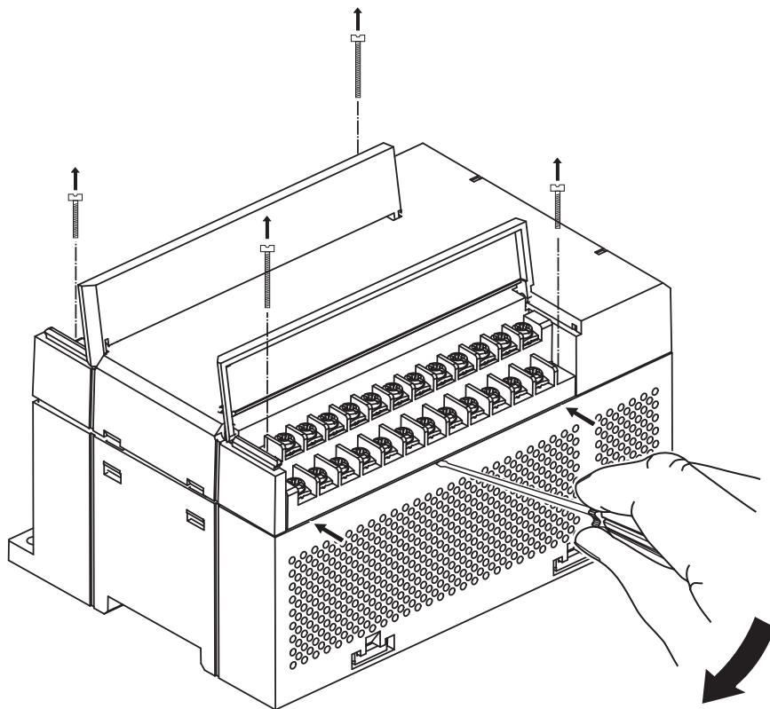
**Рисунок 4.4 – Отделение клеммной колодки от прибора MB110-224.4ТД**
