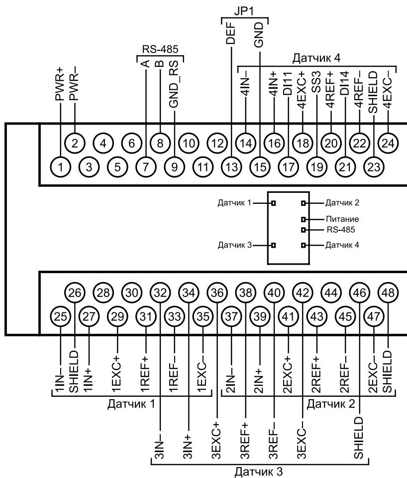
Рисунок 5.3 – Назначение контактов клеммной колодки МВ110-224.4ТД
